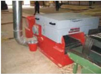
Mit speziellem Ketteneinzug und an eine Absaugung angeschlossen
