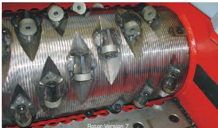
Konkave 4-Eckschneidkronen sind bis zu 4-mal wendbar
