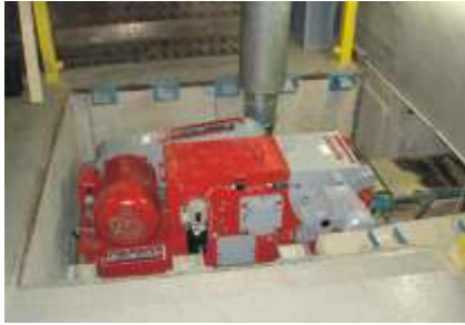
Zerkleinerung von Restholz einer Plattensäge mit einem Horizontalzerkleinerer RHZ 400 S Unterflur aufgestellt
