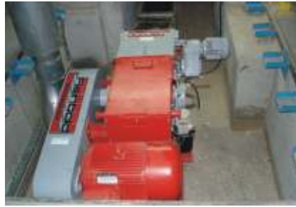
Zerkleinerung von Restholz einer Plattensäge mit einem Horizontalzerkleinerer RHZ 400 S Unterflur aufgestellt
