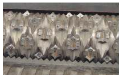
Konkave 4-Eckschneidkronen sind bis zu 4-mal wendbar
