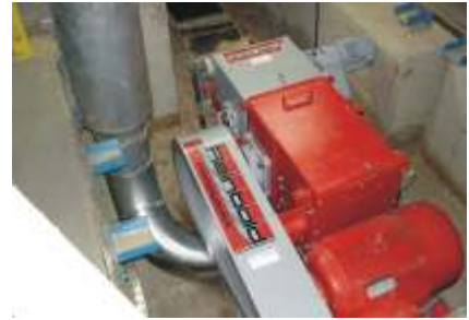
Zerkleinerung von Restholz einer Plattensäge mit einem Horizontalzerkleinerer RHZ 400 S Unterflur aufgestellt
